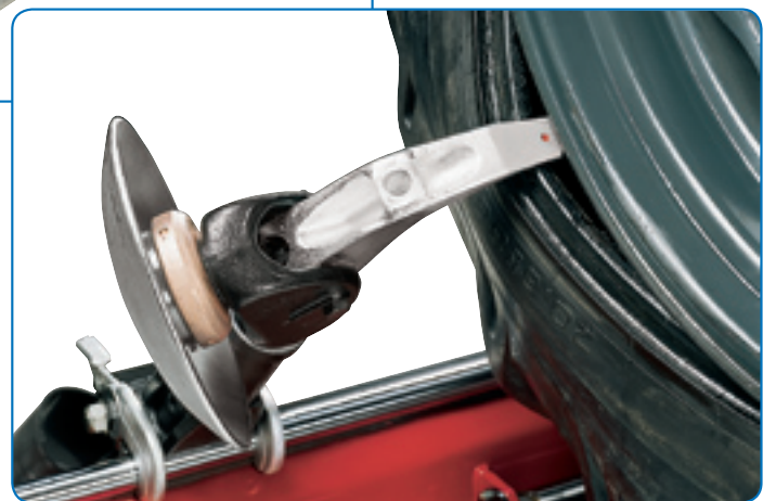
› Demounting the tyre Fase de desmontaje neumático
