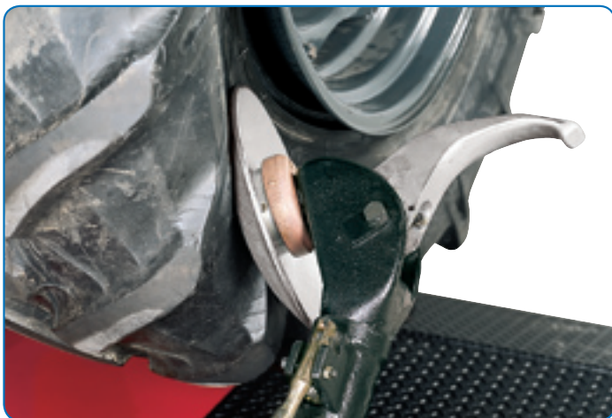
› Pneumatic bead breaking Fase de destalonadura neumático
