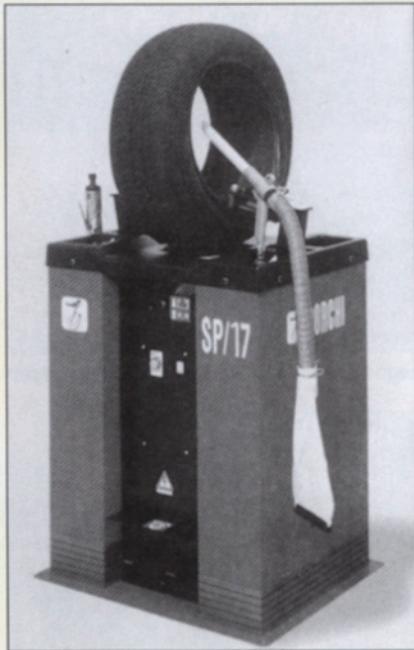
Lekkie stanowisko kontrolne do sprawdzania stanu wewnętrznych powierzchni opon samochodów osobowych
