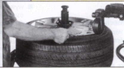
Zautomatyzowana montażownica z pneumatycznym podnośnikiem i hydraulicznymi siłownikami, pracująca bez kontaktu narzędzi z obręczą
