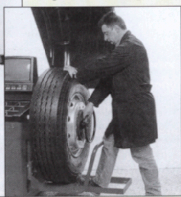
Komputerowa wyważarka z poziomym wrzecionem, podnośnikiem kół i osłoną ograniczającą obsługiwane średnice ogumienia
