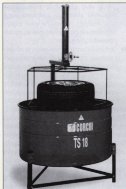
Urządzenie do mycia kół i prób szczelności ich ogumienia
