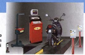
gio delle ruote agevolano la prova, assicurando il motociclo alla pedana. È dotato di sensori per misurare il peso della moto in dinamica (fino a 1.000 kg con precisione 1 per cento).
