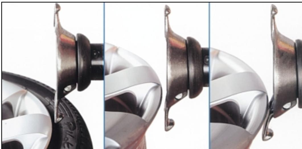
Qui sopra, la sequenza di penetrazione dell'artiglio destinato ad agganciare il tallone del pneumatico. Una volta disceso, un attuatore pneumatico fa in modo di allargare l'utensile in direzione del canale, per facilitare l'aggancio del tallone.
