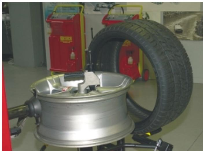
In alto a sinistra, il kit alzatalloni in azione. Sollevando il pneumatico da una zona diametralmente opposta a quella della testina portautensili, si facilita ancor più lo smontaggio. L'operatore in pratica non deve neanche toccare la copertura.
