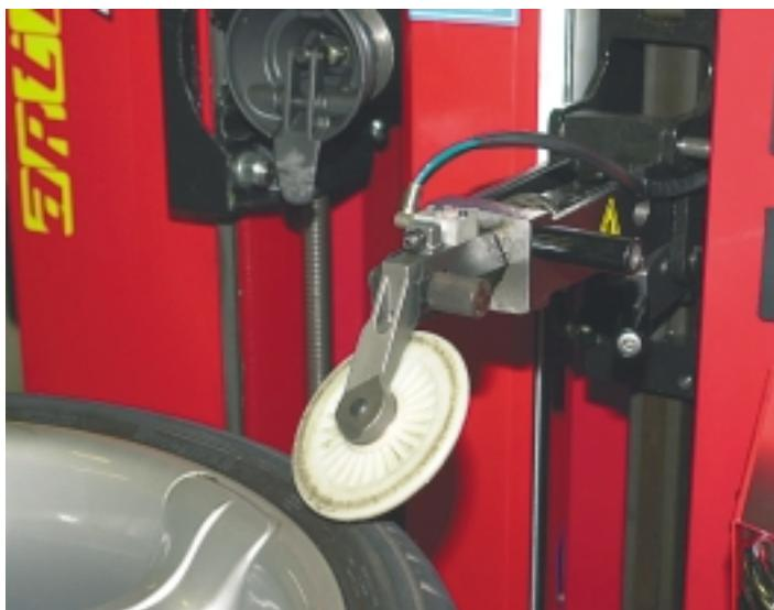
impegnata nella soluzione di questo spinoso problema realizzando un macchinario in grado di stallonare i pneumatici, e proseguire con la loro estrazione, senza minimamente toccare il cerchione, se non per il suo centraggio sul mandrino.
