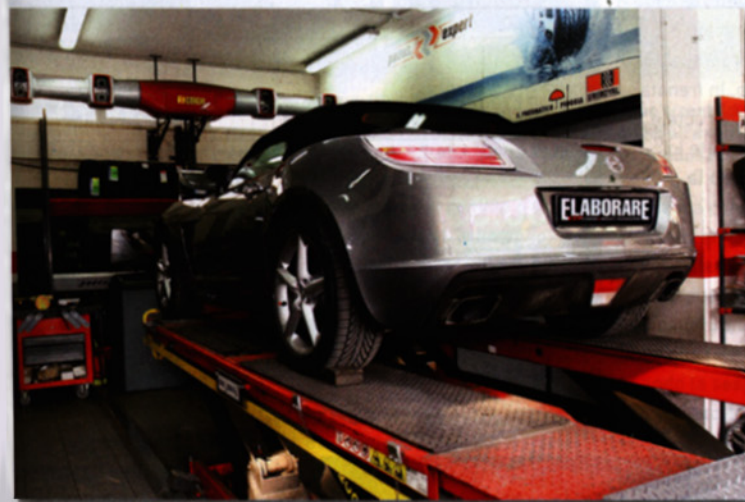
La Opel GT sul banco di allineamento ruote Corgi che si avvale di un sofisticato sistema di telecamere, nella foto in alto a sinistra, per misurare gli angoli caratteristici delle ruote.
