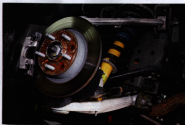
La ruota posteriore della Opel GT; in evidenza le regolazioni per modificare gli angoli caratteristici e l'architettura della sospensione a doppi bracci ad "A" sovrapposti.
