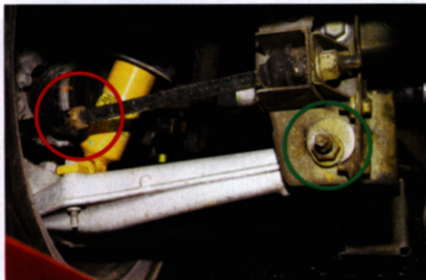
Le regolazioni della sospensione posteriore della GT. Il cerchio verde identifica uno dei due eccentrici sul braccio inferiore che permette di regolare la campanatura e l'incidenza. Quello rosso invece, indica il bullone che consente di variare la lunghezza del tirante per modificare la semiconvergenza.
