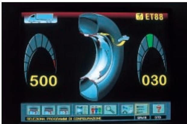
Il display mostra la schermata di apertura della ET 88 presente all'interno della scuola tecnica dell'azienda di Correggio. Durante la prima fase dell'equilibratura, l'unità comunica al tecnico di installare sul cerchio due pesi rispettivamente di 500 e di 30 grammi, posizionandoli in determinati punti ben definiti. Per pneumatici industriali il margine d'errore è di circa 10 grammi
