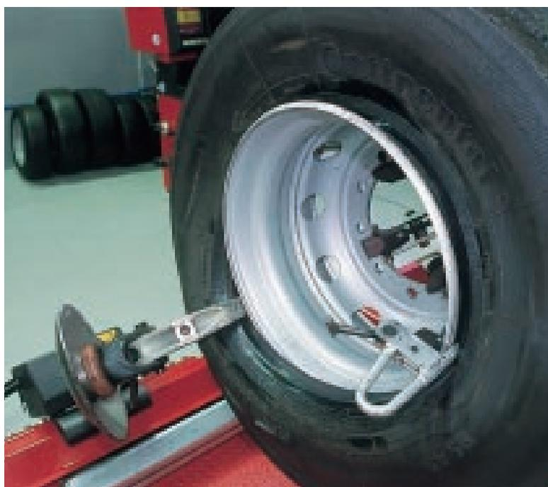
**Utilizzando un'opportuna leva il pneumatico viene installato nel cerchio. Qui si intravede anche l'utensile premitallone, o manina, utile per mantenere bloccato il pneumatico durante il suo montaggio**
