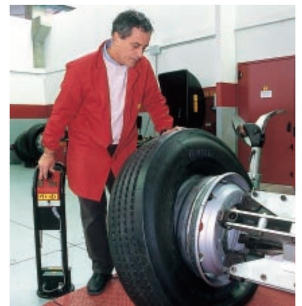
**Il montaggio del pneumatico del nostro camion. In primo piano si può notare il mandrino dell'autocentrante idraulico, funzionante a due velocità per ogni senso di rotazione, in grado di reggere un peso massimo di 1200 kg**
