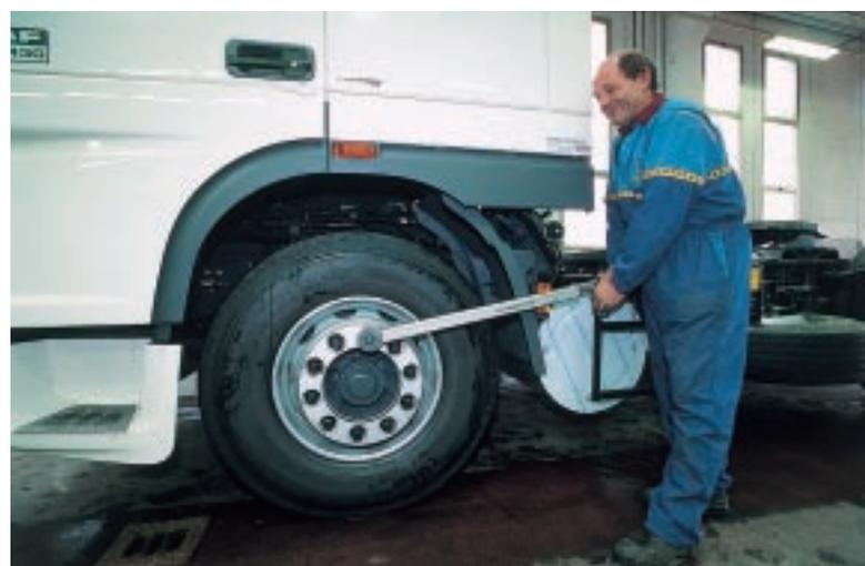
Montato il pneumatico, si esegue il serraggio dei dadi del cerchio. Un'operazione che richiede precisione di coppia e quindi l'uso di una chiave dinamometrica
