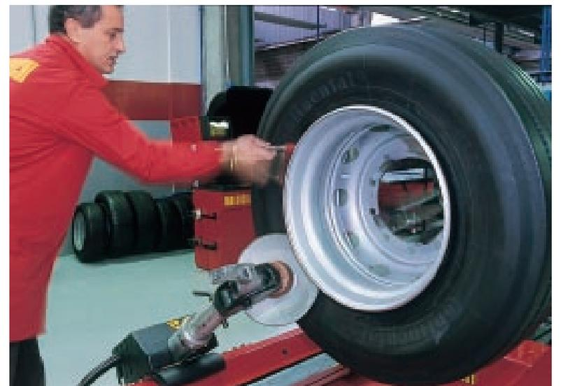
**Il pneumatico è stato stallonato. Il tecnico della Corghi ha impiegato poco più di due minuti per eseguire lo smontaggio del pneumatico**
