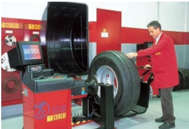
In alcuni casi, il meccanico può installare questi pesi anche all'interno del pneumatico. Come si può facilmente osservare, quest'equilibratrice fa uso di quattro frecce, un pulsante di avvio (start) e uno di stop. Esiste anche un help interattivo. Dopo aver definito teoricamente il corretto posizionamento dei pesi, il tecnico, facendo uso di un apposito martelletto-pinza, blocca i pesi in piombo
