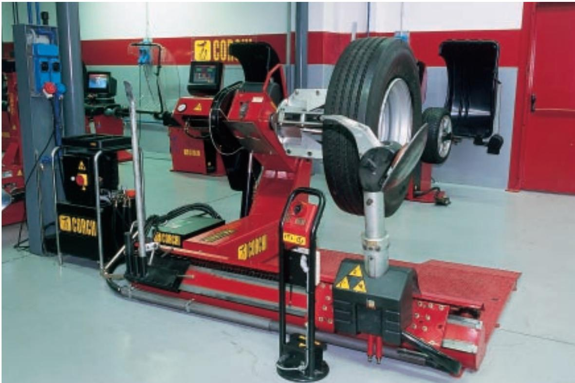
Uno dei modelli più diffusi di smontagomme superautomatiche dell'azienda di Correggio, pronto a smontare un pneumatico 315/80R 22,5". Si tratta della versione HD 1200 RC caratterizzata da una capacità operativa su pneumatici della larghezza massima di 1220 mm e di diametro massimo di 2500 mm
