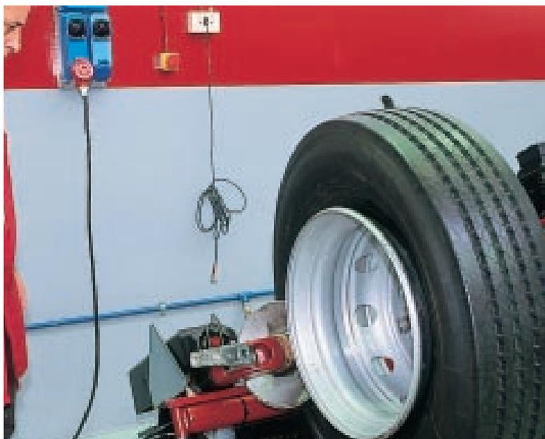
**Anche in questo caso, come è possibile osservare, la stallonatura del pneumatico avviene facendo uso del disco stallonatore che, automaticamente e senza rovinare il cerchio, entra tra il cerchio stesso e il pneumatico. La velocità di rotazione del mandrino è di circa 7 giri/min**
